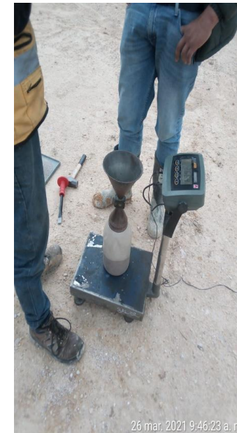
Toma de ensayo de densidades
