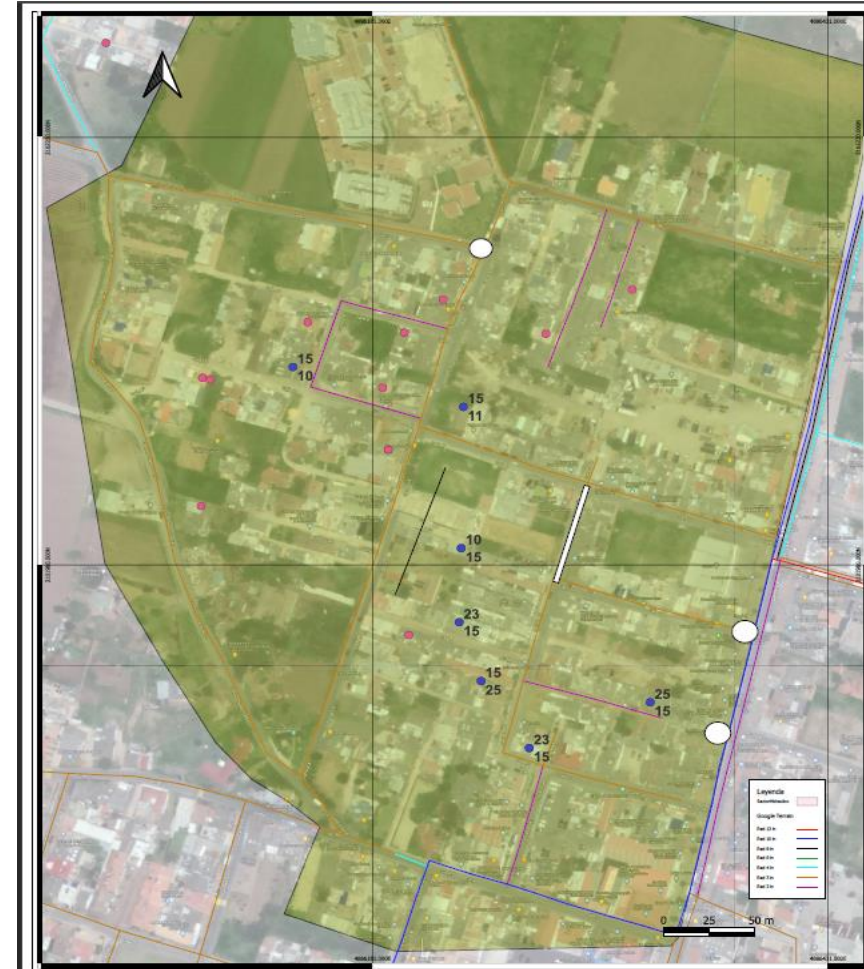
En la imagen derecha se observa el resultado final donde se logro compensar las presiones a 12 mca en horas de máximo consumo en el municipio, lo que permite contar con presiones nocturnas hasta de 20 mca de manera homogénea, garantizando el abastecimiento de los usuarios que cuentan con tanque y los que no.
